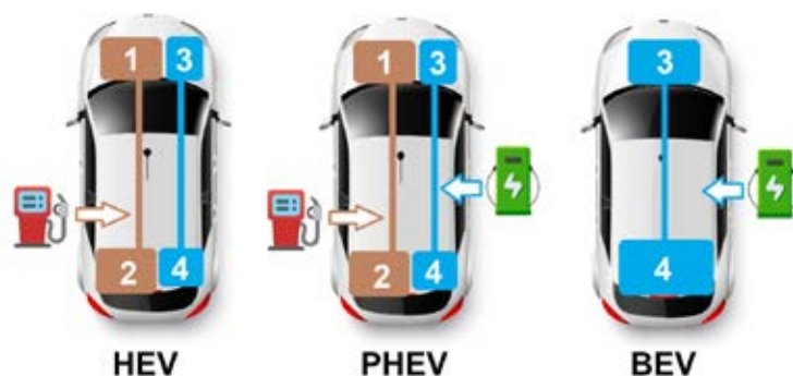
Rysunek 1. Rodzaje pojazdów elektrycznych (1 - silnik spalinowy; 2 - zbiornik paliwa; 3 - silnik elektryczny; 4 - akumulatory)
